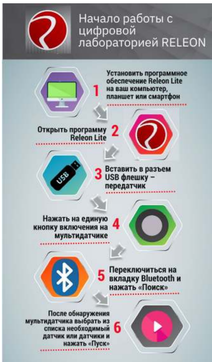
Рис. 14. Алгоритм работы с программным обеспечением Releon Lite
