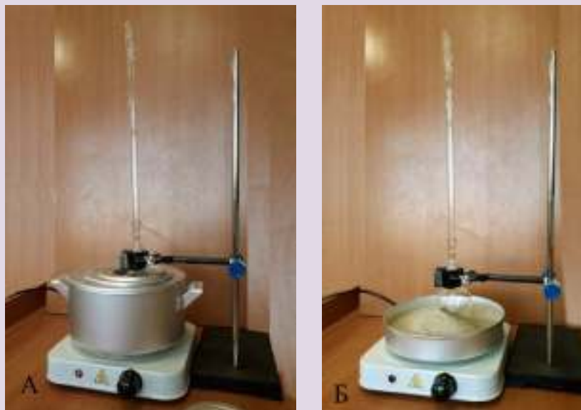
Рис. 6. Баня комбинированная лабораторная. А — водяная баня. Б — песчаная баня
